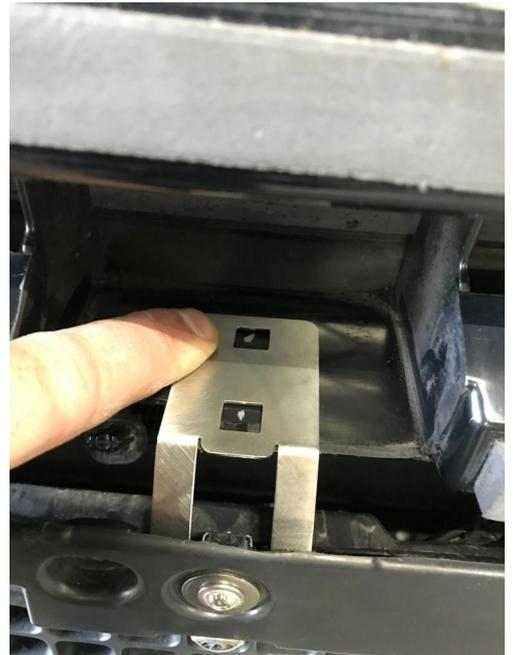
Montieren Sie den Edelstahlbügel mit Hilfe der Schrauben M5x20 und der Käfigmutter m5.
