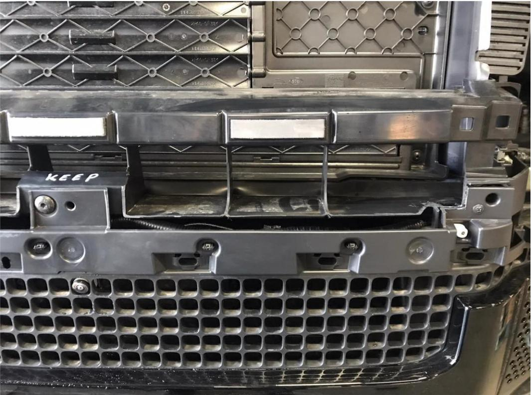
3.2 Schneiden Sie den mittleren Kunststoff des Gitters wie unten gezeigt aus
