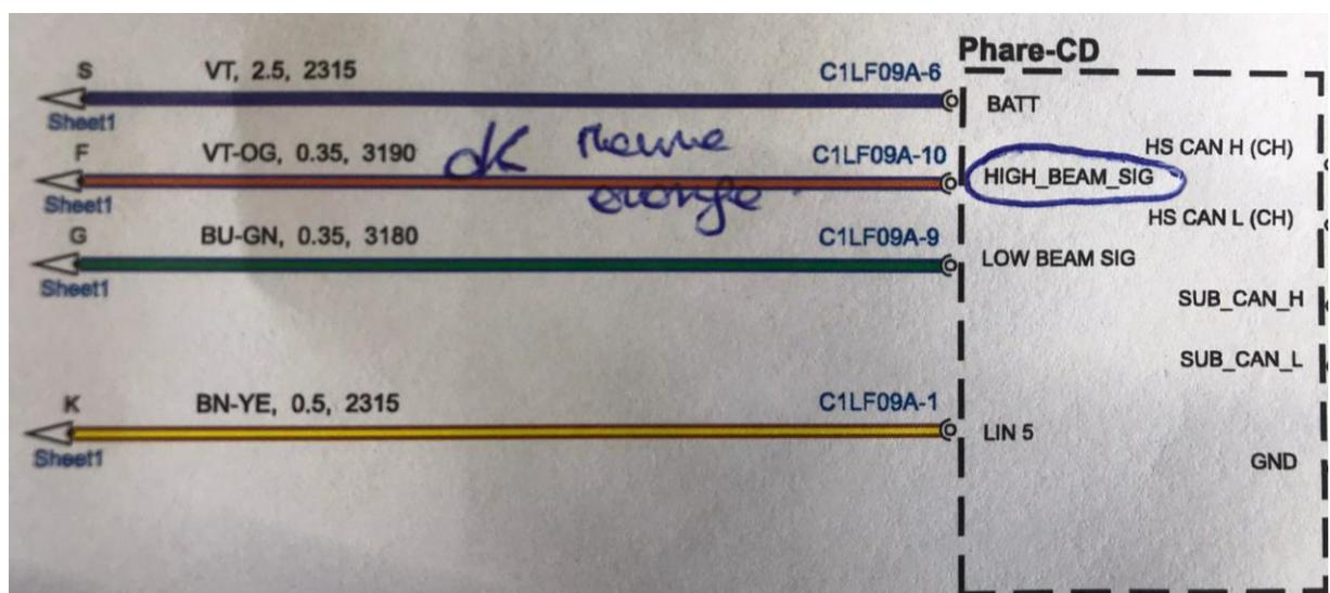
Dieser Vorgang dient dazu, das Steuersignal der großen Scheinwerfer zu extrahieren, um den LED-Balken gleichzeitig zu steuern.
