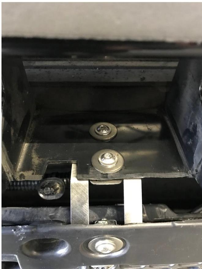
4. Bohren Sie ein Loch in den Kunststoff, um die M8x20-Befestigung, die Unterlegscheibe und die Sicherungsmutter zu platzieren.
