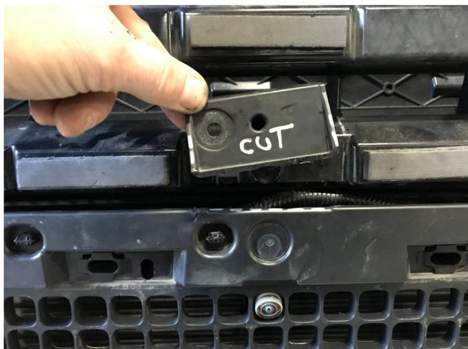
Schneiden Sie die Innenseite des Kühlergrills aus, wobei die Unterseite intakt bleibt.
